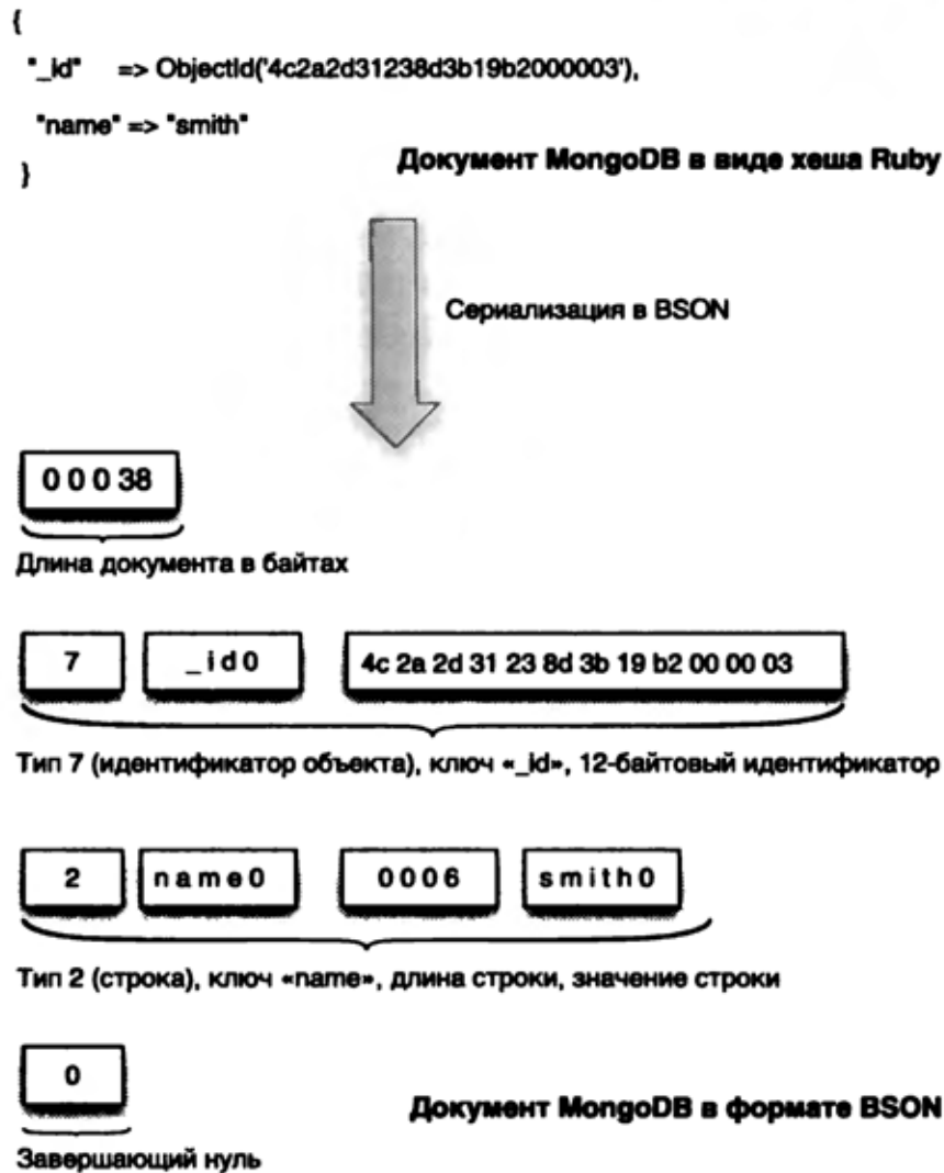
Рис. 3.2. Преобразование из Ruby в BSON
