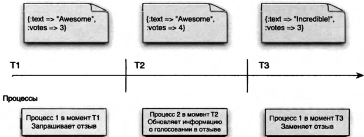
Рис. 6.4. При одновременном использовании направленного обновления и обновления заменой возможна потеря данных
