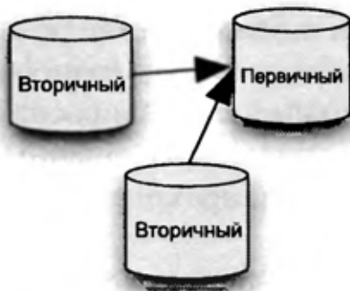
Рис. 1.3. Автоматическая обработка отказа с помощью набора реплик
